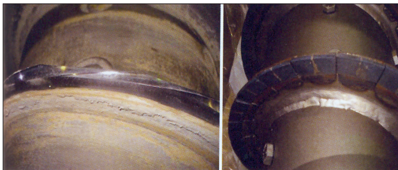
شکل ۱۵ (چپ) و ۱۶ (راست): سایش هلیس و صفحه‌های سائیده شده
